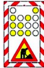
Semnalizarea unui utilaj care se deplasează lucrând
