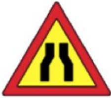
Drum îngustat pe ambele părți
